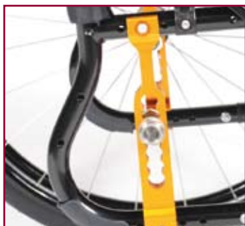
Altura de asiento ajustable en 7 posiciones. Con 4 posiciones del camber (de 0 a 4°) y pletina del eje disponible en 3 colores anodizados (Naranja, Negro y Gris plata)
