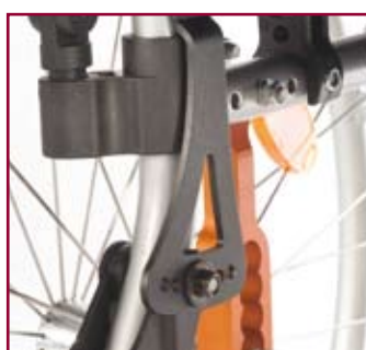
Respaldo ajustable en ángulo (opcional). Ligero y fácil de ajustar. La pletina del eje ofrece un ajuste en ángulo desde -12° a +12° (en incrementos de 4°)
